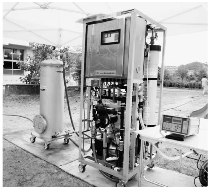
田辺市東部小学校に配備された災害用造水装置
