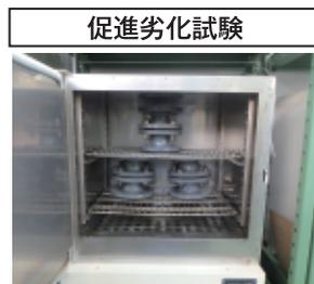
恒温槽で加熱による促進劣化後、水密試験を実施し、100年相当の水密性想定値13MPa(初期性能の約7割)を保持
