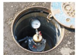
水圧測定(ラクエア+圧力計)
