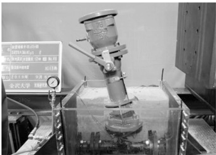
湿潤な細砂に拘束されても可とう性能を保持(衝突後の観察状況)
