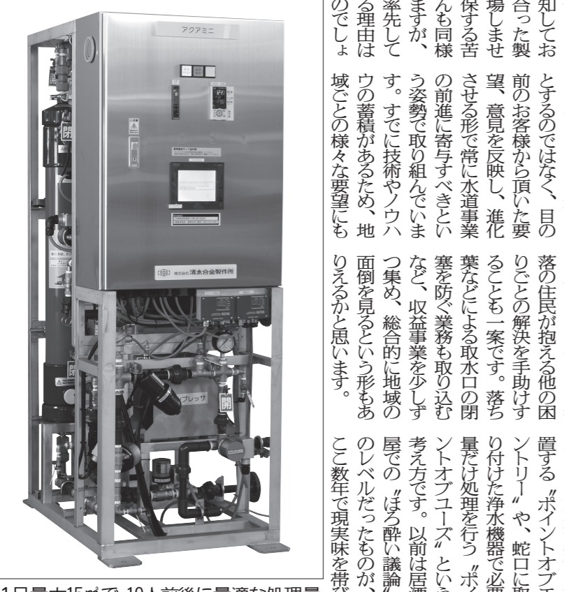
1日最大15m³で、10人前後に最適な処理量
