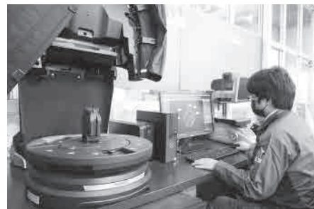
最新の3Dスキャナ使い部材の寸法測定正確に
