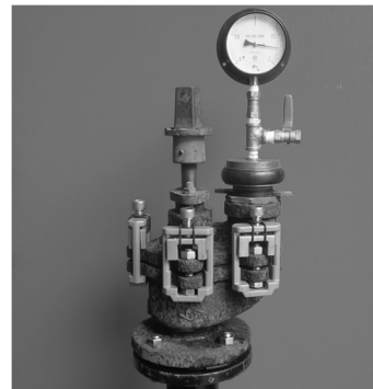
図4 耐圧試験、弁座漏れ試験
