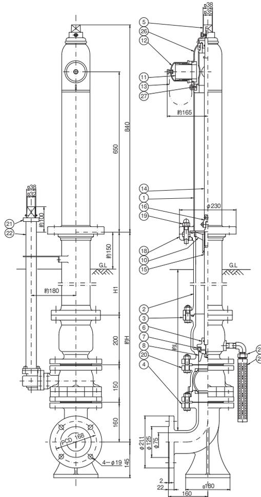
補修弁・乙管付
